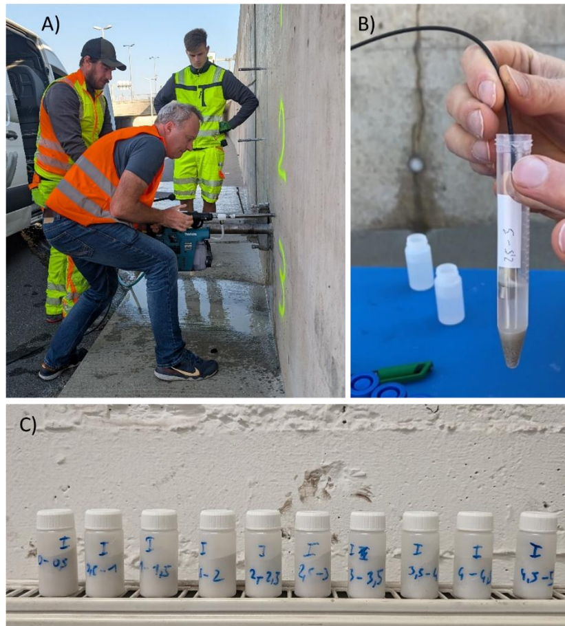
Abbildung 2.6.1: Veranschaulichung der Probennahme (a), der optischen pH Messung (b) und der gewonnenen Bohrmehlfraktionen (c).
